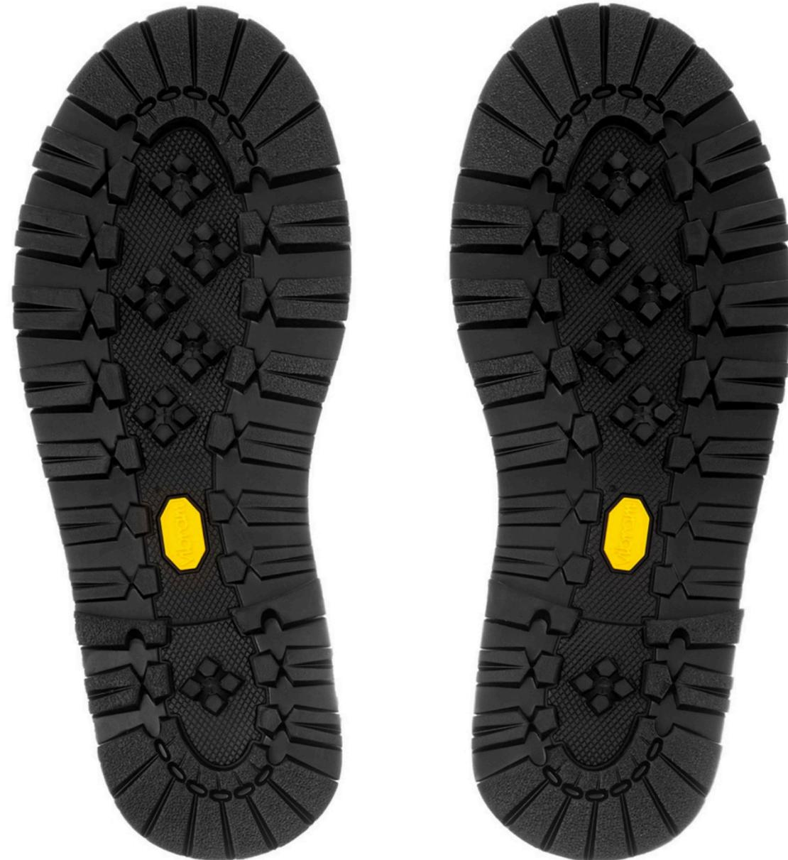
Nel settembre del 1935 **Vitale Bramani** assiste a un grave incidente in cordata a causa di calzature inadeguate. Applica la **gomma vulcanizzata** alle soles delle scarpe garantendo così la stabilità degli scarponi chiodati, la flessibilità e la presa sulla roccia. Per migliorare l'aderenza e la trazione disegna dei tasselli a forma di croce: le soles potevano così drenare all'esterno neve e detriti fangosi, oltre a garantire una buona presa.
